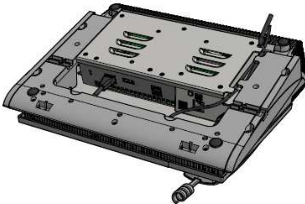
Figure 4.1: Connexion des câbles d'alimentation et Ethernet pour les modèles IP-3102 et IP-3108
